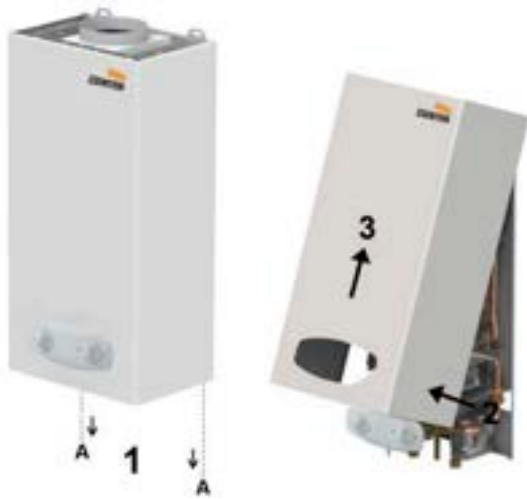
fig. 18 - Démontage de l'habillage
